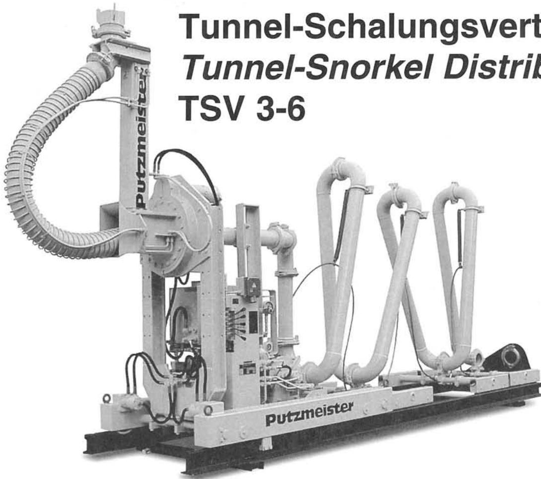
Der Schalungsverteiler TSV 3-6 läßt sich stufenlos an Tunnel-Durchmesser von 3 bis 6 m anpassen. Eine standardmäßige Rohrschere erlaubt Betonierfortschritte von 8,5 m ohne Umsetzen des TSV.
