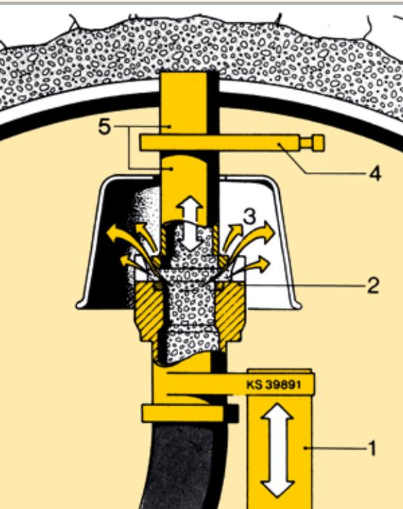
Die Überdruckautomatik des Putzmeister TSV verhindert ein Verbiegen der Schalung. Der Schnorchel hebt automatisch ab, wenn der Betondruck am Stutzen einen einstellbaren Wert von 1-10 bar überschreitet.
