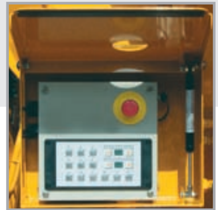
Die Bedieneinheit für den Betrieb der Maschine und zur Anzeige von Pumpdaten ist serienmäßig
