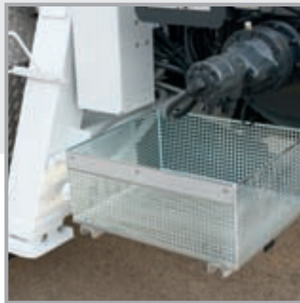
Ablagemöglichkeit: Im Gitterkorb kann Zubehör gleichzeitig noch gereinigt werden
